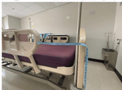
圖 1. 床尾護欄與床板間隙
