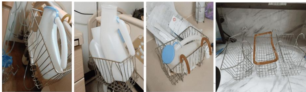
圖 1. 受電動床擠壓變形的尿壺架
