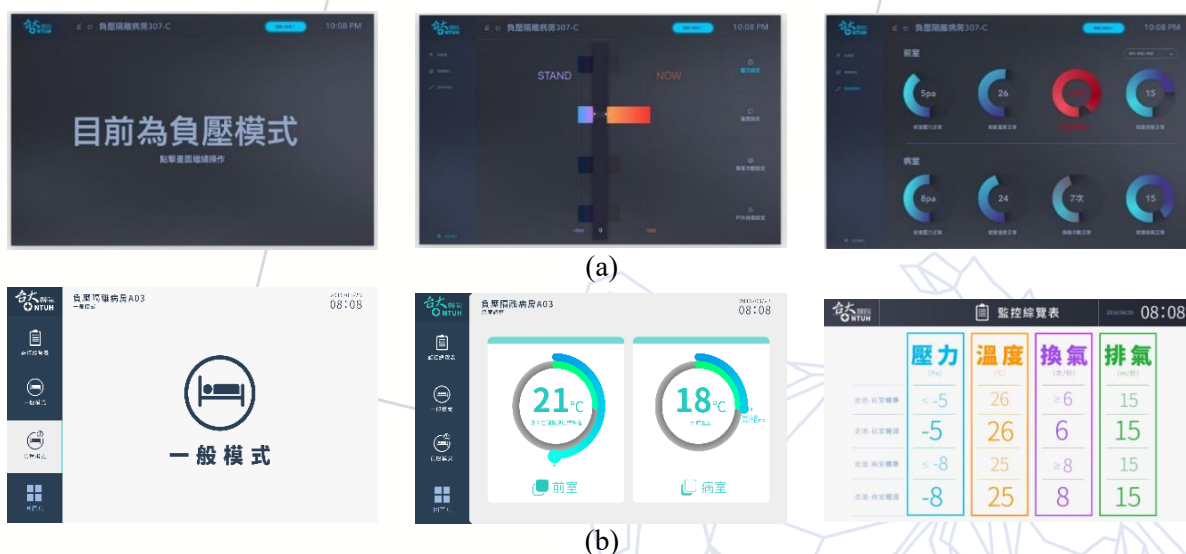
圖 7. 負壓隔離病房空調系統新型介面設計過程：(a)A 版；(b)B 版
