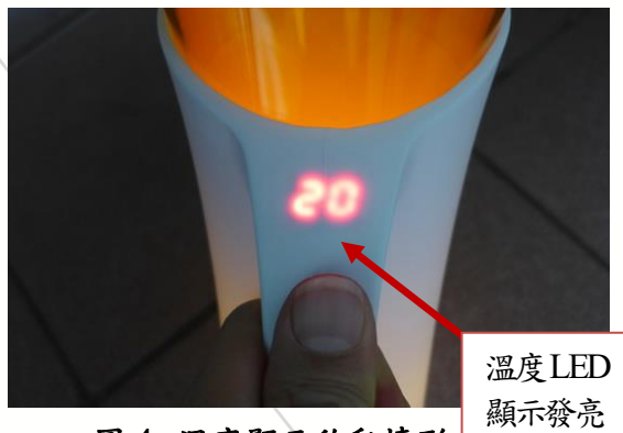
圖 4. 溫度顯示啟動情形
