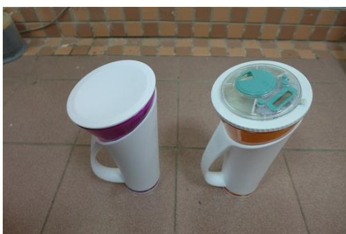
圖 6. 一般杯蓋與藥盒杯蓋的智能水杯
