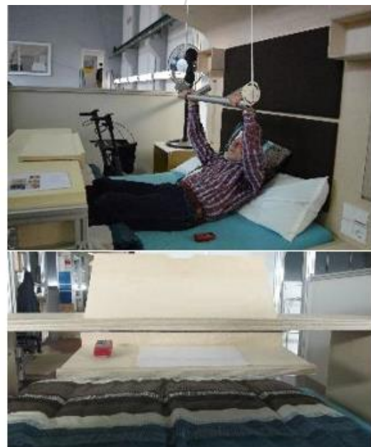
圖 19. 床終端。左上方：不顯眼的安裝把手；右上方：遙控把手；左下方：滑軌上的整合式桌子，右下方：展開的整合式桌子
