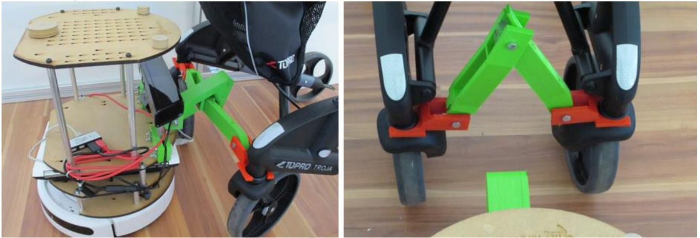
圖 13. TurtleBot 透過助行車與機器人之間的連接器拖動助行車
