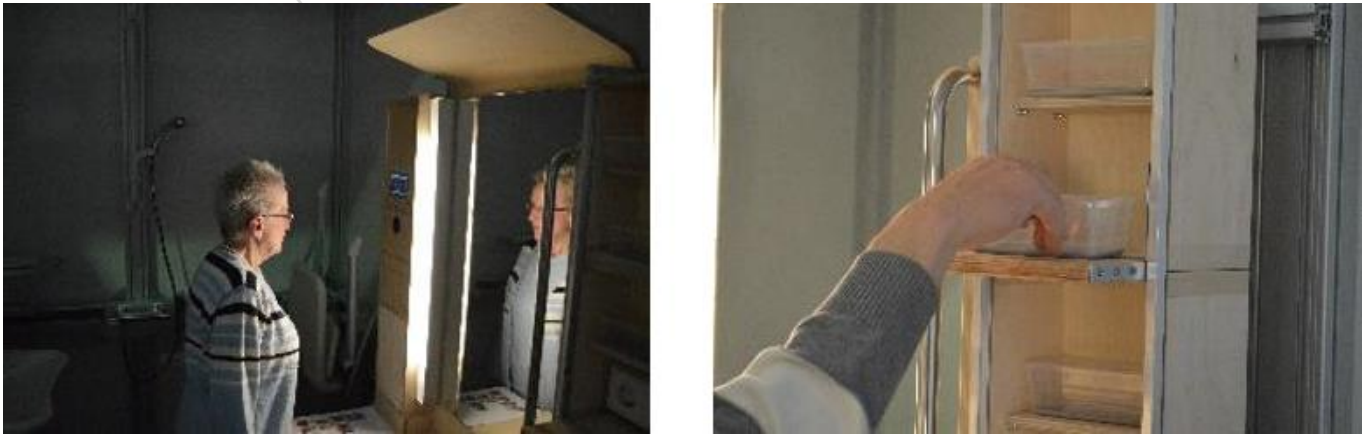
圖 20. 浴室終端。左圖：測試發燒檢測器；右圖：測試模型櫥櫃升降系統
