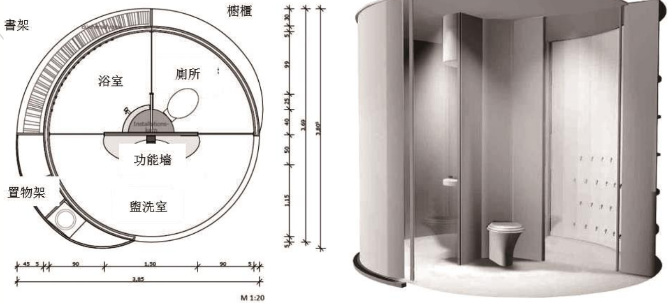
圖 6. 一體化的浴室單元設計(Bock et al., 2012a)
