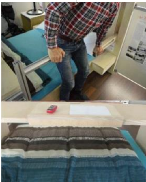
圖 19. 床終端。左上方：不顯眼的安裝把手；右上方：遙控把手；左下方：滑軌上的整合式桌子，右下方：展開的整合式桌子
