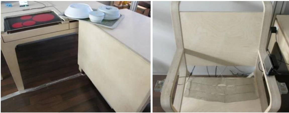
圖 16. 客廳終端。左圖：行動平台隱藏在桌子中，可由放置在桌上的小型觸控式螢幕自動驅動和控制； 右圖：設置在測試椅子扶手兩側的電容式電極模組
