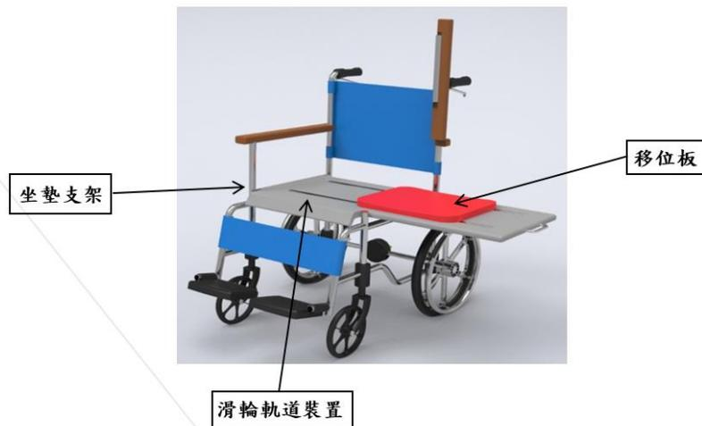
圖 3. 移位機坐墊各部分圖示
