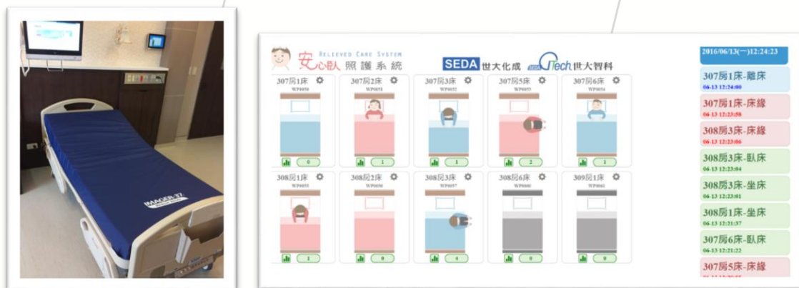
圖 2. WhizPad 提供三階段離床報知 (坐床、床緣、離床) 功能
