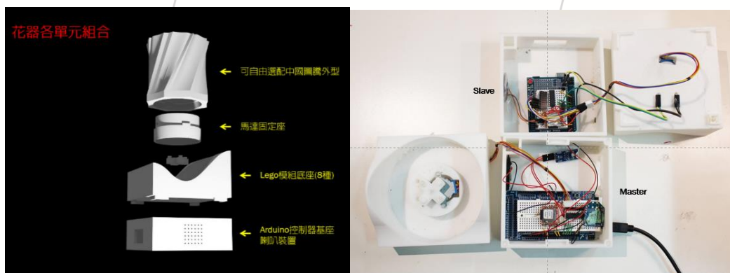
圖 6. 左圖為互動花器之整體 3D 列印元件；右圖為底座之控制器(Cerebellar)互動機制
