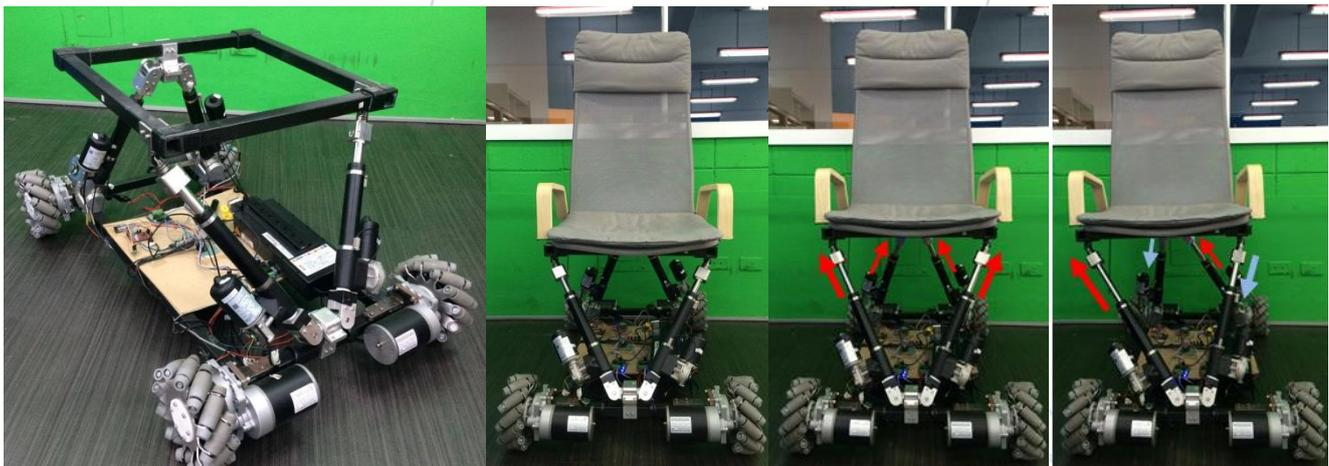
圖 3. 碳纖維骨架機器人輪椅硬體原型與動作
