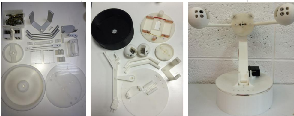
圖 3. 傳統加工（左）和 3D 列印（中）製作之零件比較，及 3D 列印之 Wobot（右）
